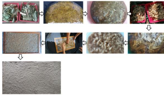
ภาพที่ 1 กระบวนการผลิตแผ่นวัสดุจากเยื่อต้นข่า
